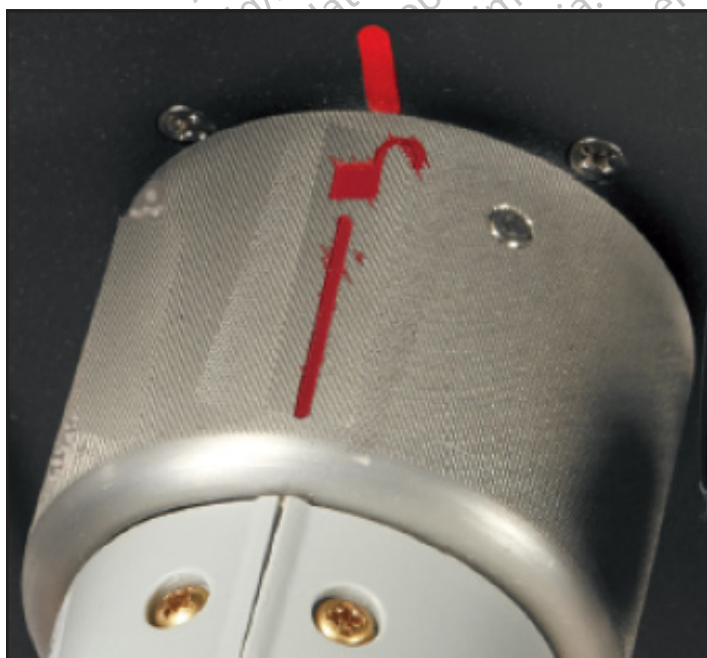
19 pav. Jungiamosios dėžutės laidų laikiklio dujų linijos atjungimas (dujų jungties įvorė atfiksavimo padėtyje)
