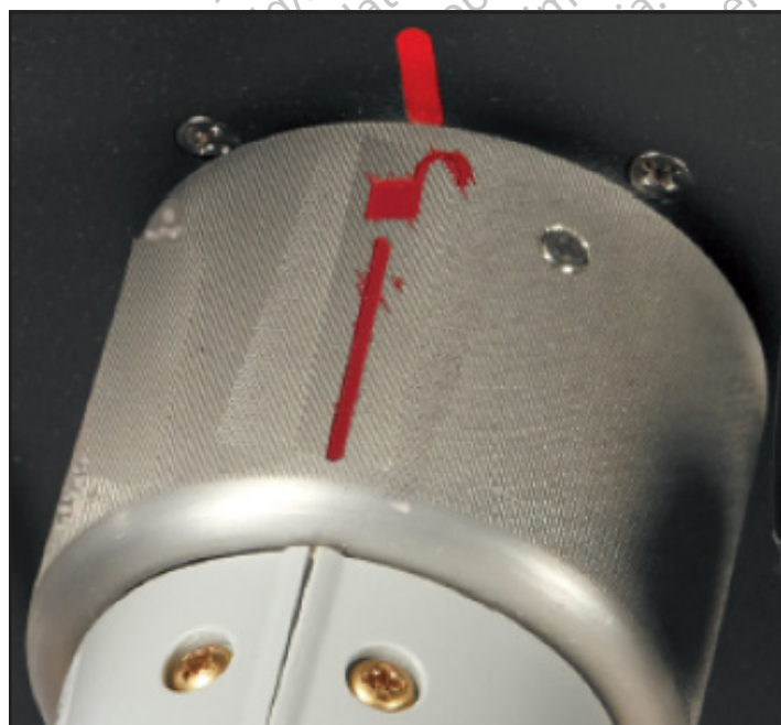
19. attēls. Savienojumu kārbas instalācijas gāzes pievades līnijas atvienošana (gāzes savienojumu rumba atbloķētā stāvoklī)
