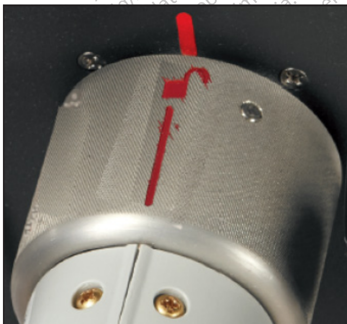
Obrázok 19. Odpojenie plynovej hadičky spoja spojovacej jednotky (hrdlo plynovej prípojky v odistenej polohe)
