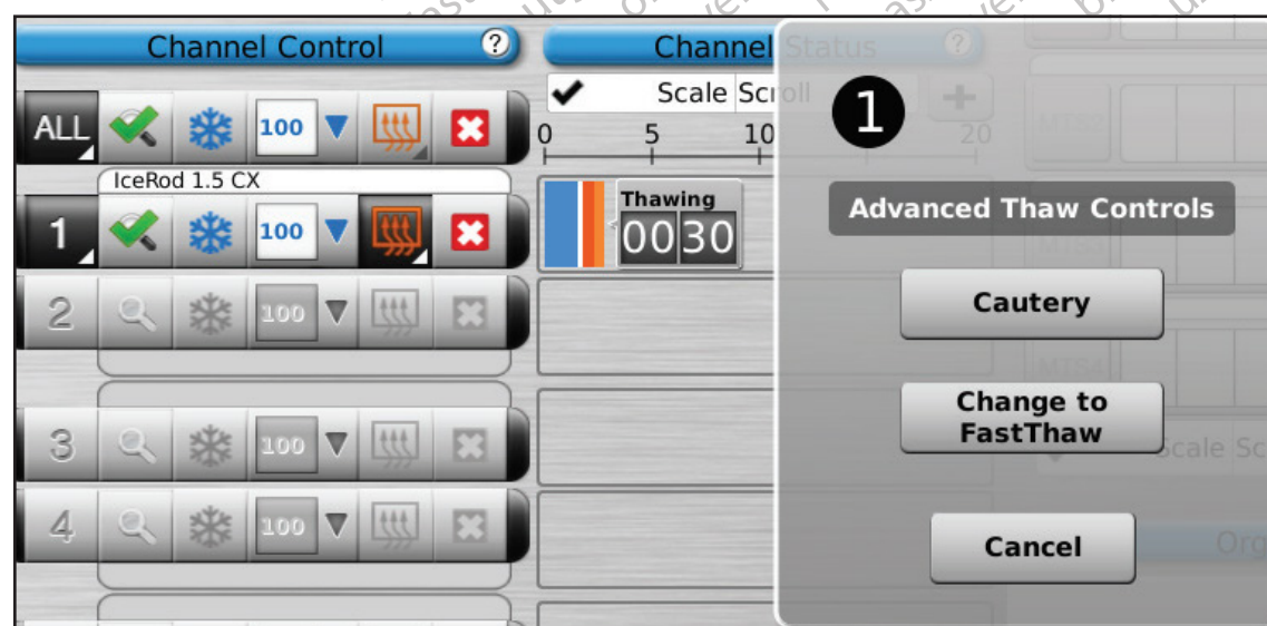
Ekran 33. Advanced Thaw Controls (Zaawansowane sterowanie rozmrażaniem) – funkcja FastThaw
