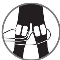
Figura 3: Orientação e alinhamento correctos dos pensos de retorno na extremidade superior da secção intermédia da coxa
