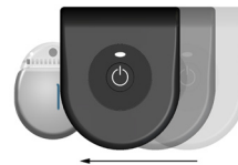
Obrázek 7. Zarovnání pravého okraje nabíječky
