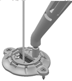
Şekil 20. Tutucu Klipsi Taban Üzerine Yerleştirin
