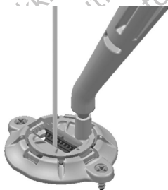
Рисунок 20. Расположение фиксатора на основании
