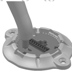
Рисунок 41. Введение инструмента для размещения/удаления
