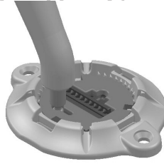
Şekil 41. Yerleştirme/Çıkarma Aracını Yerleştirme
