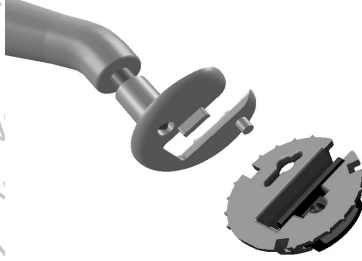
Şekil 19. Tutucu Klipsi Aletin At Nalı Ucuna Takın
