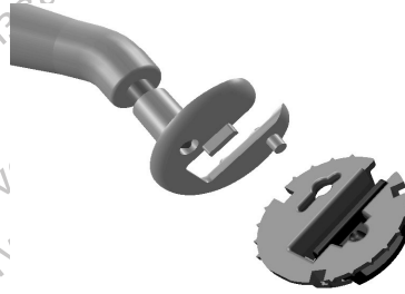
الصورة 19. تركيب مشبك الاحتجاز بطرف الحدود لأداة
