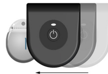
obrázok 5. Zarovnanie pravej strany nabíjačky
