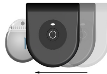
Rysunek 5. Wyrównanie ładowarki do prawej krawędzi
