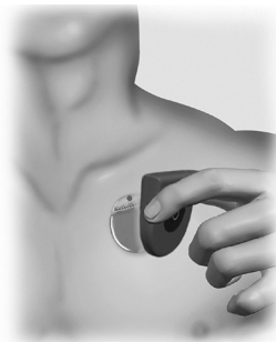
Obrázek 4. Umístěte nabíječku nad stimulátor
