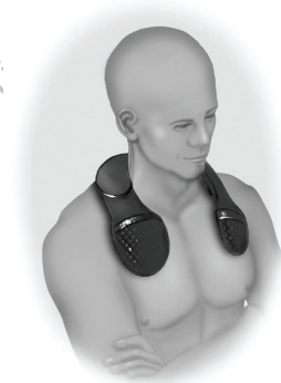
Figura 2. Collar de recarga colocado sobre el cuello
