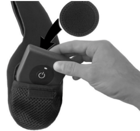
Abbildung 1. Platzieren des Ladegeräts und des Ladesystem-Abstandshalters in der Tasche
