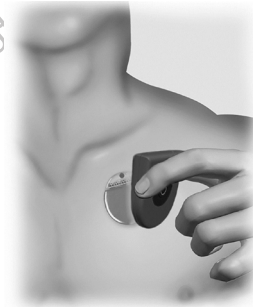
Afbeelding 4. Positioneer de oplader boven de stimulator
