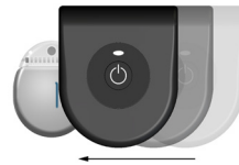
Figure 5. Alignement de l'arête droite du chargeur
