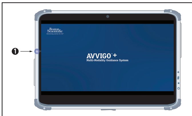
Figura 3. Indicador de alimentación de AVVIGO+
