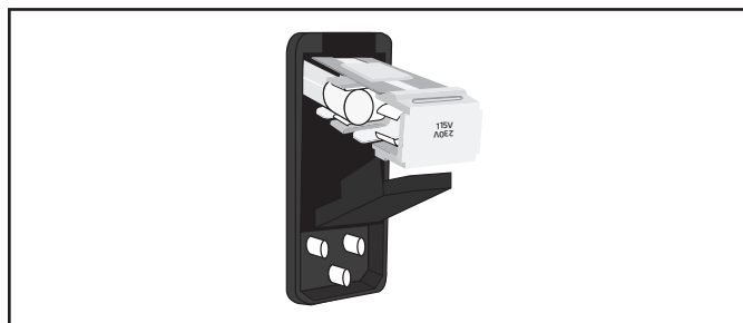
Figura 77. Extraer el portafusibles
