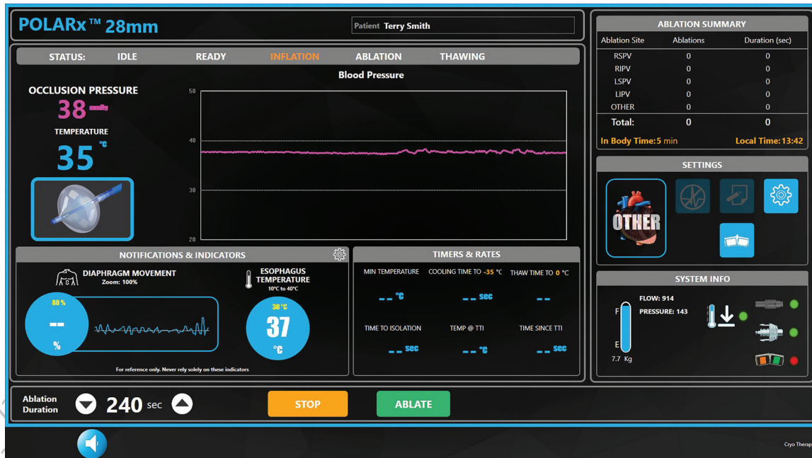
Figura 15. Pantalla Therapy (Terapia) en estado inflado con gráfico de presión
