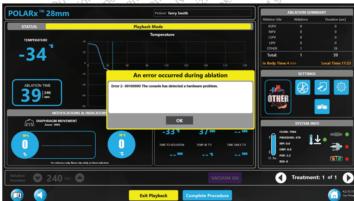
Slika 28. Sporočilo o napaki, prikazano v načinu Playback Mode (Način predvajanja)
