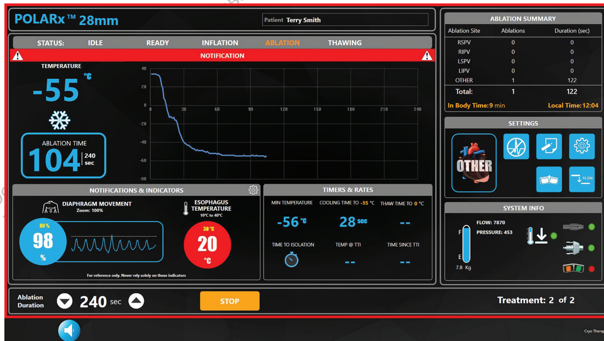
Slika 8. Upozorenje Esophagus temperature (Temperatura jednjaka)
