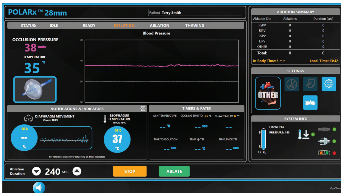
Slika 15. Zaslón Liječenje – stanje napuhivanja s grafikonom tlaka
