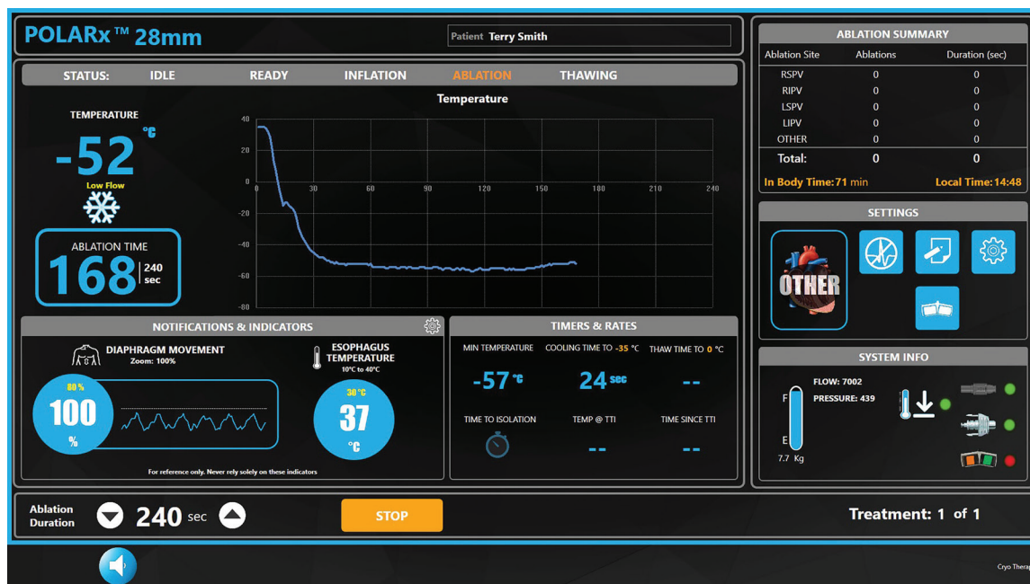
Ilustracja 18. Funkcja Low Flow (Niski przepływ) jest aktywowana
