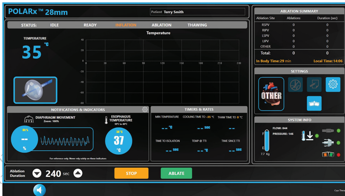
Obrázek 14. Obrazovka Therapy (Terapie) – režim nafouknutí s pevným modrým okrajem, jsou-li aktivována rozšířená oznámení
