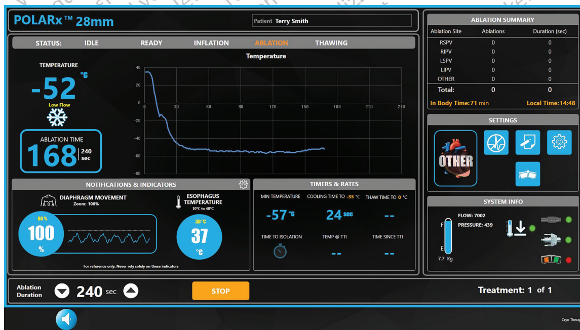
Obrázek 18. Nízký průtok je aktivován
