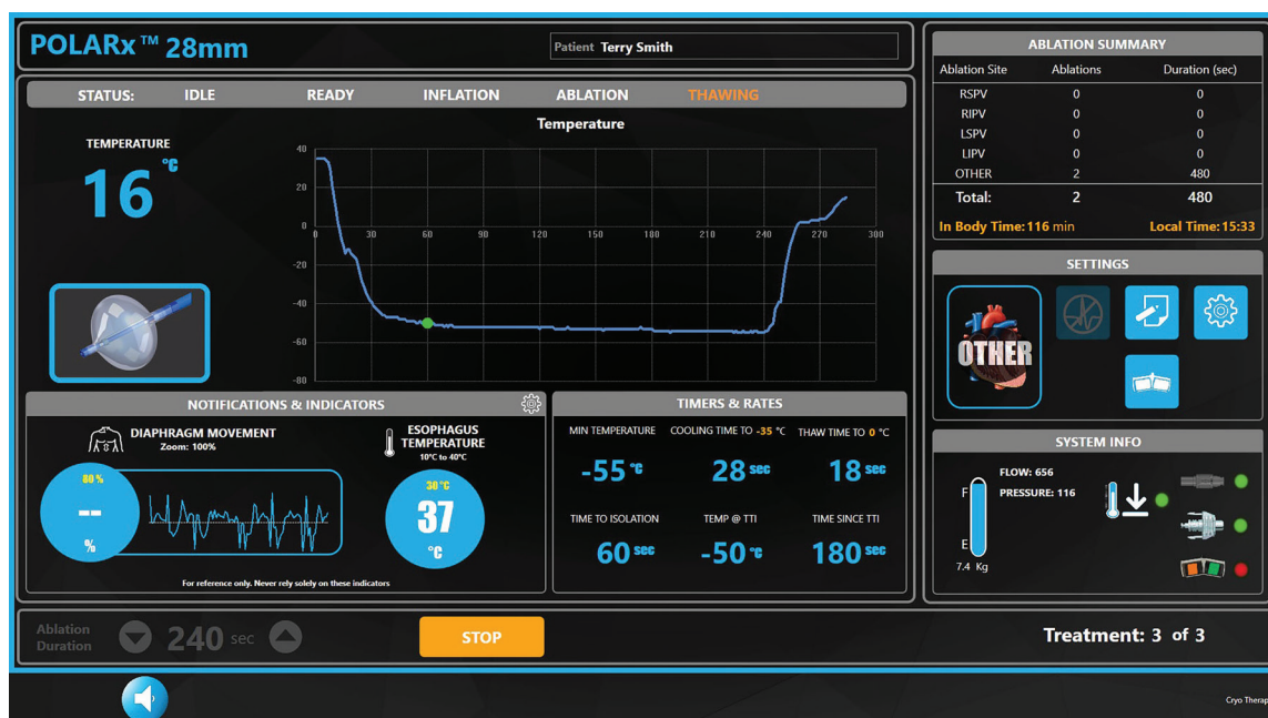
Obrázek 25. Obrazovka Therapy (Terapie) – režim THAWING (Zahřívání)
