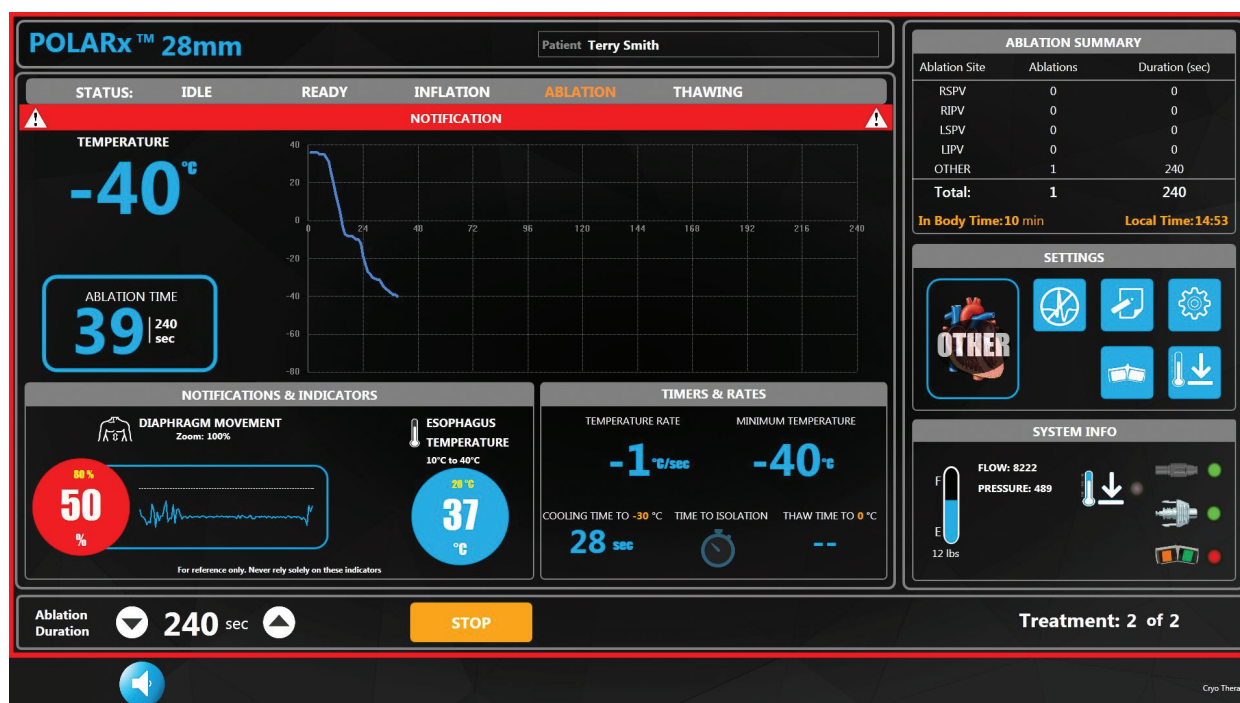
Slika 9. Opozorilo senzorja gibanja diafragme
