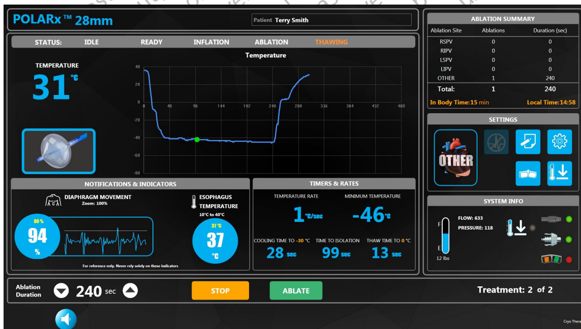
Figura 14. Pantalla Therapy (Terapia) en estado de descongelación
