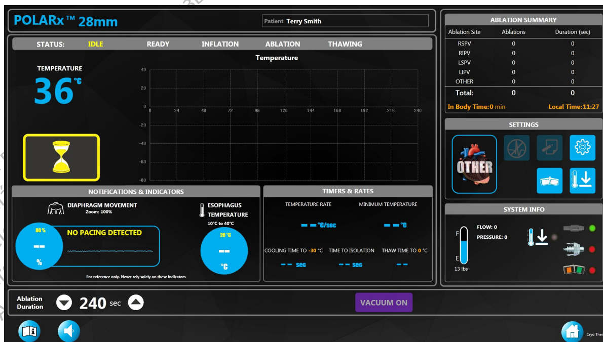
Rysunek 5. Ekran Therapy (Terapia) – stan bezczynności – prawidłowy cewnik podłączony
