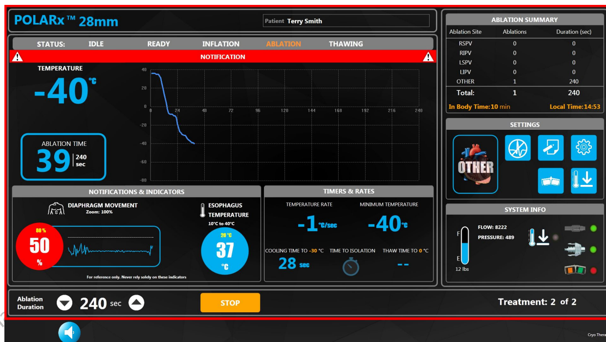
Rysunek 9. Alert czujnika ruchu membrany
