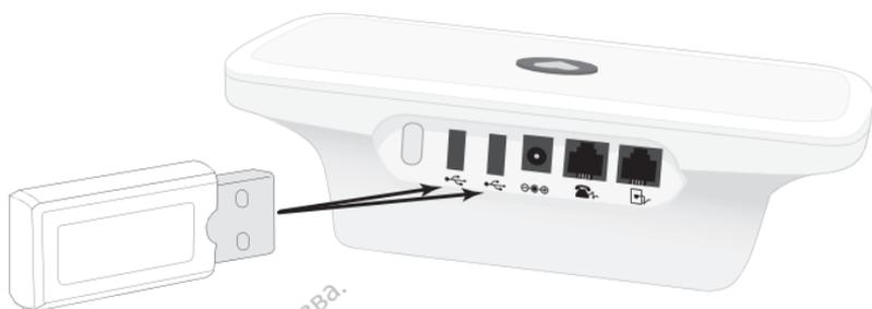
**Abbildung 9. Anschließen des USB-Zubehöradapters**
