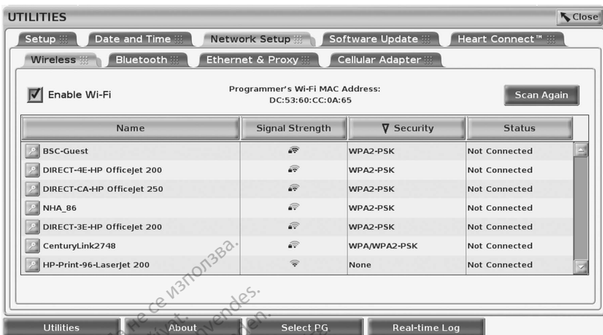
Εικόνα 4. Βοηθητικές λειτουργίες - Ρύθμιση δικτύου
