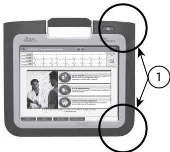
Figură 8. Vedere frontală a sistemului de programare LATITUDE ce indică Locații aproximative ale antenei în câmp
