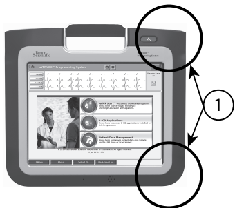
Figuur 8. Voorzijde van LATITUDE Programming System waarbij geschatte locaties van antennes binnen de behuizing worden aangegeven
