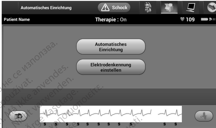
Abbildung 10: Wählen Sie die Schaltfläche „Elektrodenkennung einstellen“, um die Elektrodeninformationen einzugeben
