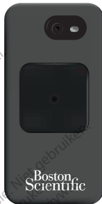
Figuur 6. Magneet bevestigd aan de behuizing van het mobiele apparaat
