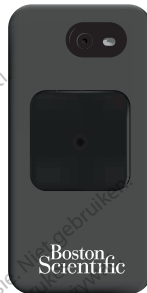
Figure 6. Aimant fixé à l'étui du dispositif mobile
