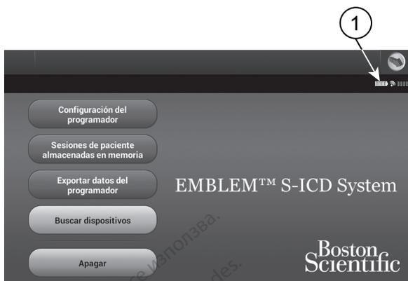
[1] Estado de la batería (las barras son visibles con la alimentación de la batería).
