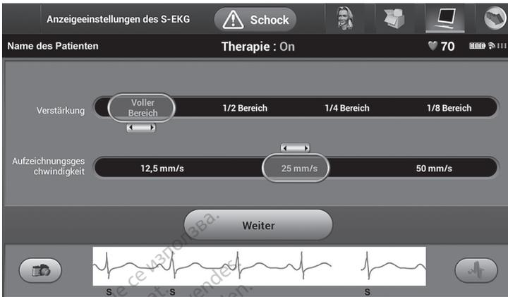
Abbildung 30. Anpassen der Verstärkung und der Aufzeichnungsgeschwindigkeit
