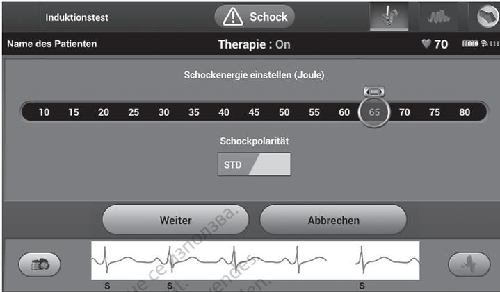
Abbildung 23. Festlegen der gewünschten ersten Schockenergie für Defibrillationstests
