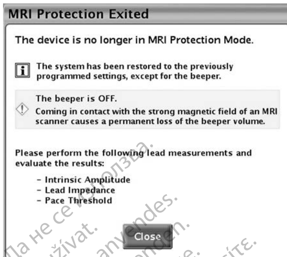
Ilustracja D-6. Okno dialogowe wyjścia z trybu ochrony podczas badania MRI
