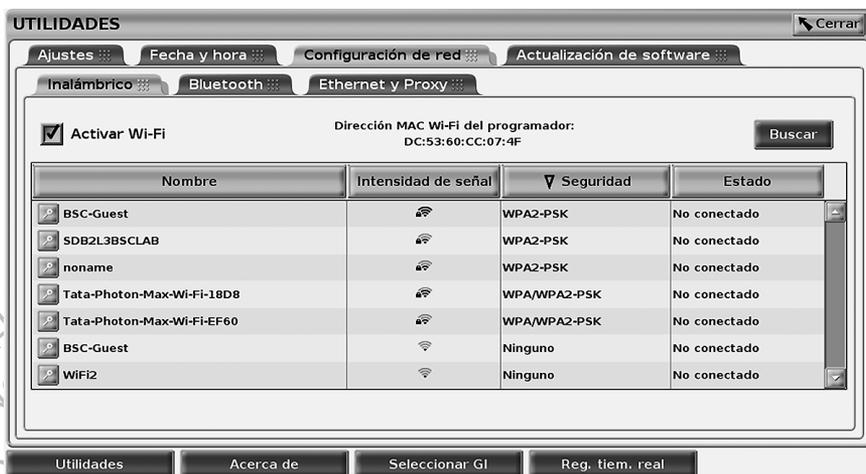
Figura 7. Utilidades - Configuración de red - Inalámbrico - Visualización de redes
