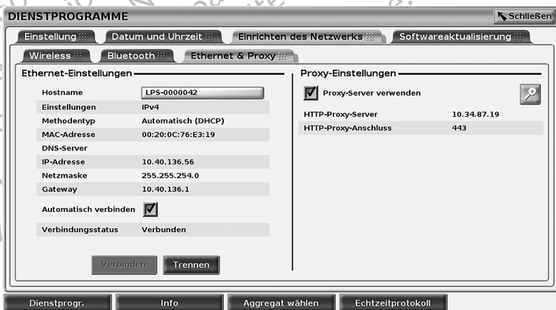
Abbildung 13. Dienstprogramme – Einrichten des Netzwerks – Ethernet & Proxy
