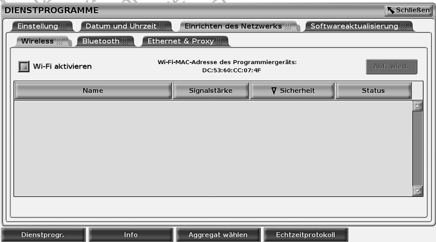
Abbildung 5. Dienstprogramme – Einrichten des Netzwerks – Wireless Aktivieren
