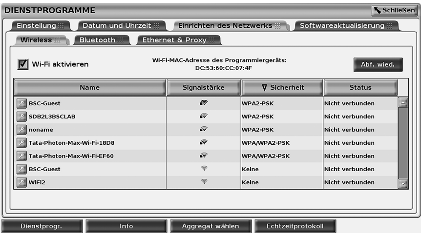
Abbildung 7. Dienstprogramme – Einrichten des Netzwerks – Wireless – Netzwerkanzeige
