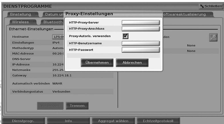
Abbildung 14. Dienstprogramme – Einrichten des Netzwerks – Proxy-Einstellungen
