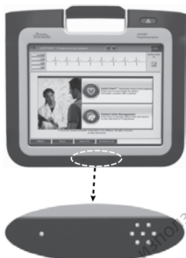
Σχήμα 26. Ανοίγματα για μικρόφωνο και ηχείο
