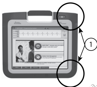
Figura 8. Vista frontal del sistema de programación LATITUDE indicando las ubicaciones aproximadas de antena dentro del cercado
