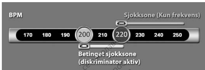
Figur 5. Diagram over detektering av frekvens i sjokksonen
