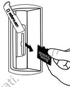
Utilice la yema de un dedo para presionar ligeramente la tarjeta de vuelta a la ranura. A continuación, deslice rápidamente el dedo antes de que la tarjeta vuelva a colocarse en su sitio. Tenga en cuenta que la tarjeta puede salir despedida cuando se expulsa.
