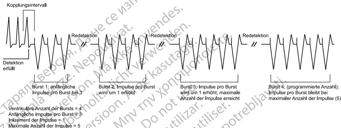
Abbildung 3–12. Interaktion der maximalen Anzahl der Impulse und Anzahl der Bursts
