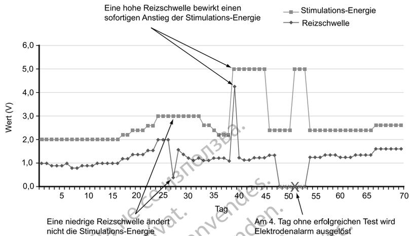
**Abbildung 4-9. Auswirkung der Reizschwellenänderung auf die LVAT-Stimulations-Energie (bei einer programmierbaren maximalen Amplitude von 5,0 V und einer Sicherheitsspanne von 1,0 V)**
