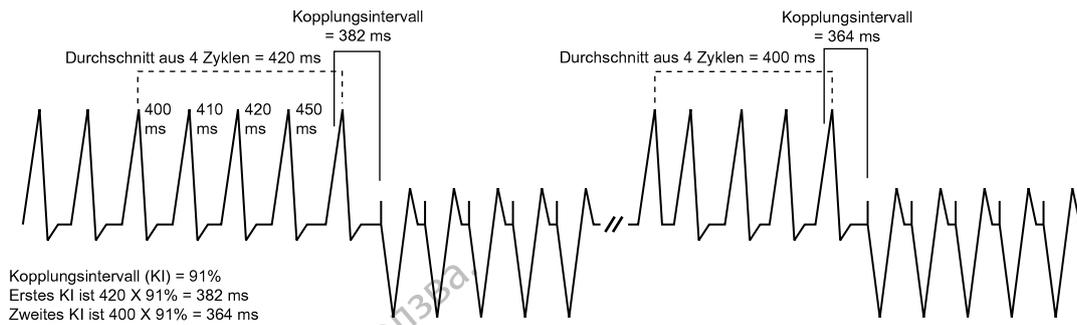
Der Durchschnitt aus den vier Zyklen wird nur dann aus den vier Zyklen vor der jeweiligen Tachykardieabgabe berechnet, wenn keine Abnahme (Kopplungsintervall oder Scan) programmiert ist.
