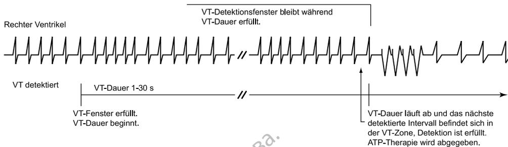
Die Dauer beginnt, wenn ein Fenster erfüllt wird, und läuft so lange weiter, wie das ventrikuläre Detektionsfenster erfüllt bleibt. Die Detektionskriterien sind erfüllt, wenn die Dauer abläuft und das nächste detektierte Intervall sich innerhalb derselben ventrikulären Zone befindet.
