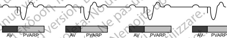
Darstellung eines 2:1-Blocks beim Herzschrittmacher, bei dem jede zweite P-Welle in das PVARP-Intervall fällt.
