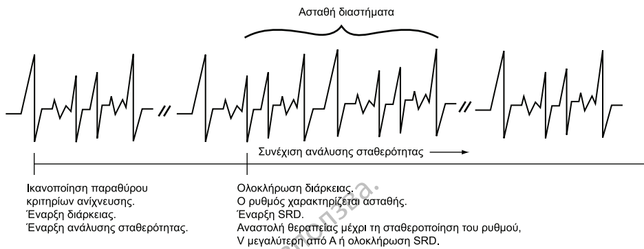
Σχήμα 2-21. Αξιολόγηση της παραμέτρου Stability (Σταθερότητα) κατά την πάροδο της περιόδου που ορίζεται από την παράμετρο Duration (Διάρκεια)
