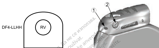
Figura 8. Collegamenti dell'elettrocatteter e posizione delle viti, VD: DF4-LLHH
