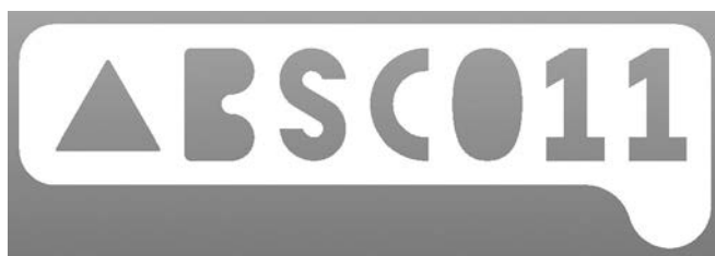
Figura 1-1. Identificador radiográfico para ADVANTIO MRI, INGENIO MRI, VITALIO MRI y FORMIO MRI
