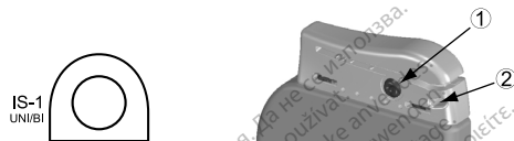
Figur 4. Elektrod koblinger og setteskrueplasseringer, RA/RV: IS1
