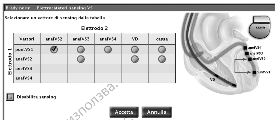
Figura 2-41. Schermata Configurazione elettrocateri di sensing per dispositivi quadripolari
