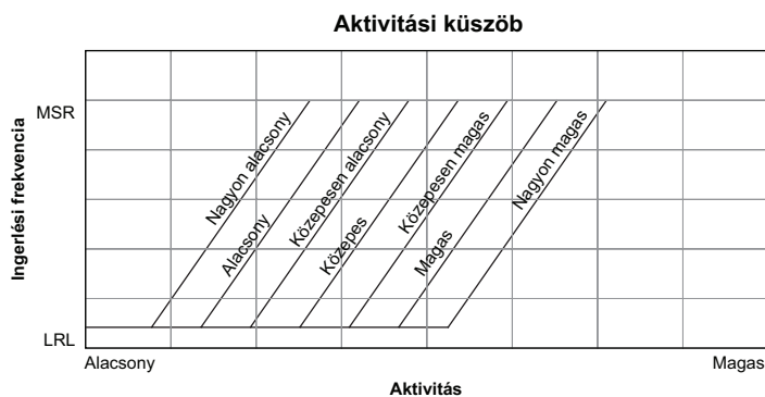
2-13. ábra Az aktivítási küszöb és a frekvenciaválasz összefüggése
