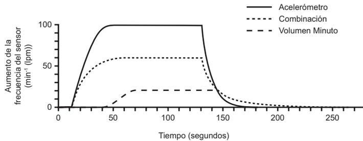
Figura 2-28. Respuesta combinada: el acelerómetro detecta movimiento con poco o ningún aumento del VM
