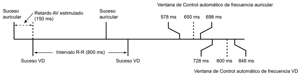
Figura 2-35. Ventana de sincronización del Control automático de la frecuencia
