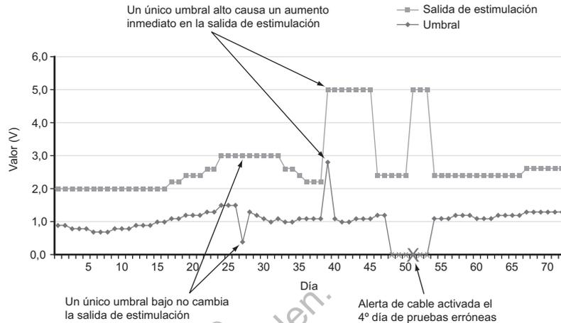
Figura 2-8. Efecto de los cambios del umbral en la salida de estimulación AUV
