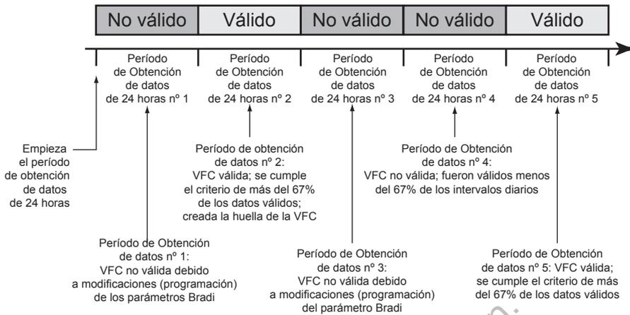
Figura 4-3. Ejemplo de obtención de datos de VFC
