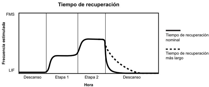
La figura muestra el efecto de los valores más altos y bajos durante una prueba de esfuerzo teórica de dos etapas.
