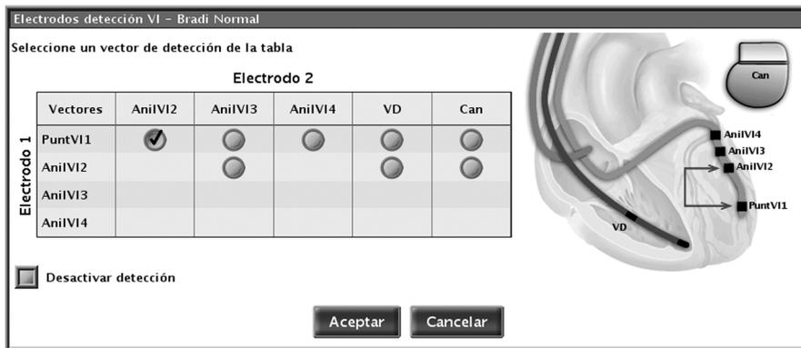
Figura 2-41. Pantalla de configuración del cable de detección para dispositivos cuadrupolares
