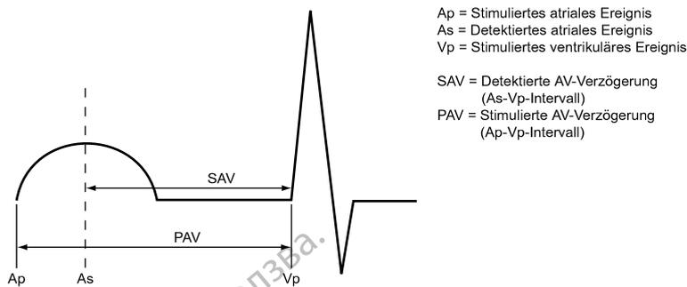
Abbildung 2-44. AV-Verzögerung bei Detektion
