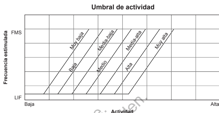
Figura 4-9. Umbral de actividad y respuesta en frecuencia
