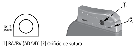
Figura 5. Conexiones del cable y localización de los tornillos, RA/RV (AD/AV): IS-1
