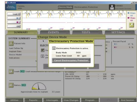
Figure 9. Écran Changer le mode du dispositif : le mode Protection bistouri électrique est activé.
