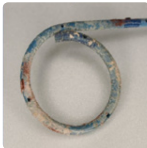
図1 短期留置例におけるステントの石灰化(元の結石の成分/留置期間)
