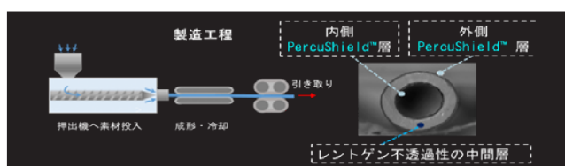
図7: トリアの製造工程と3層構造
