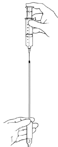
図 4-4b. チューブ先端に 15ゲージの圧媒液注入針を挿入する
